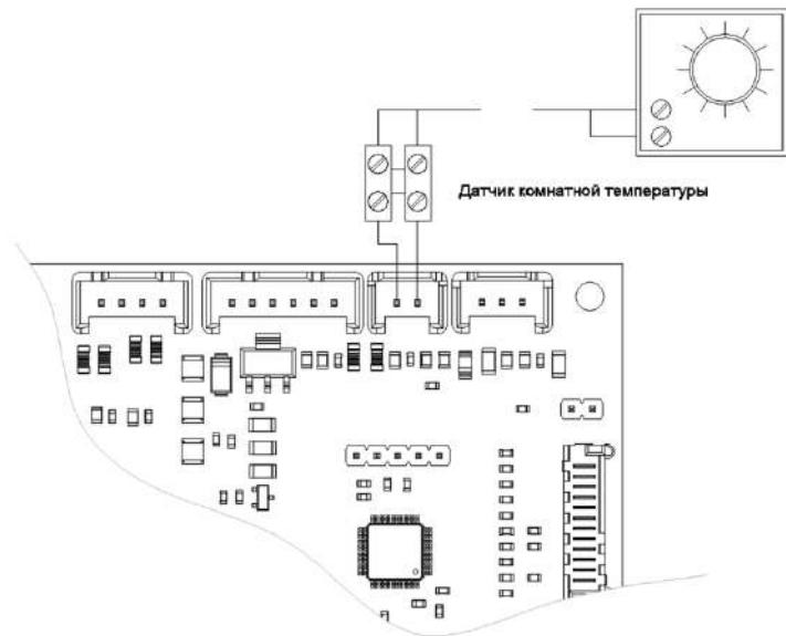
*Рис 20. Подключение датчика комнатной температуры.*
