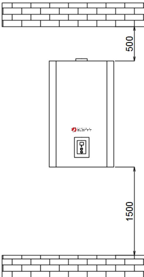
Рис 8. Установка на прямой стене.
