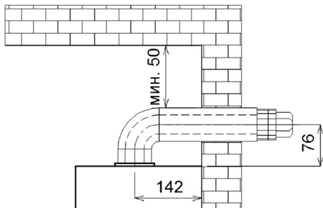
Рис 14. Монтаж дымохода.
