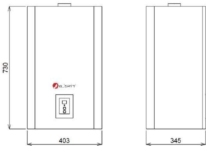
Рис. 2. Габаритные размеры.
