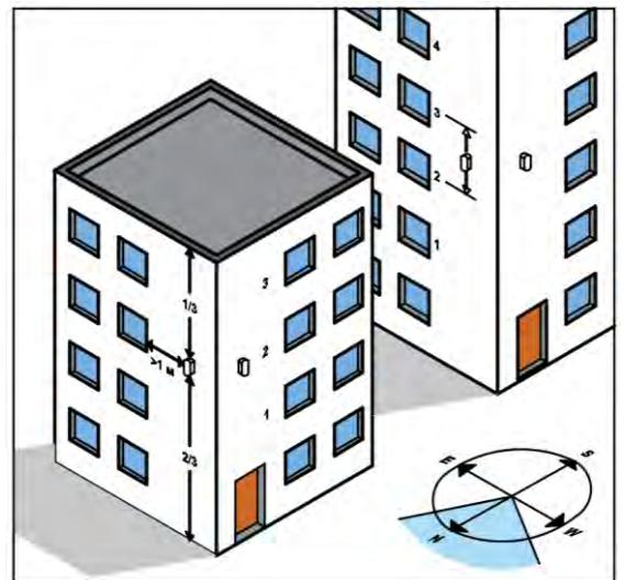
*Рис 18. Расположение датчика уличной температуры*
