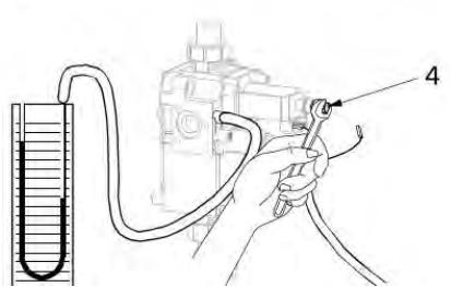
Рис 29. Проверка (настройка) давления газа.
