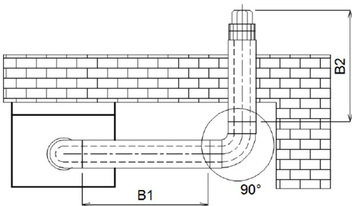
Рис 13. Расчет длины дымохода.
