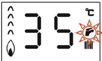
**ВАЖНО:** для использования режима горячего водоснабжения, ручка регулирования температуры должна стоять на требуемом значении температуры в диапазоне от 35 °С до 57 °С. Если регулятор температуры воды горячего водоснабжения будет установлен в минимальное положение, то при открытии крана горячей воды котел не перейдет в режим ГВС. Кроме того, суммарный расход воды горячего водоснабжения должен быть минимум 2,5 л/мин.
