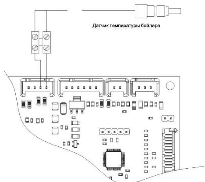
Рис 17. Подключение датчика бака-водонагревателя
