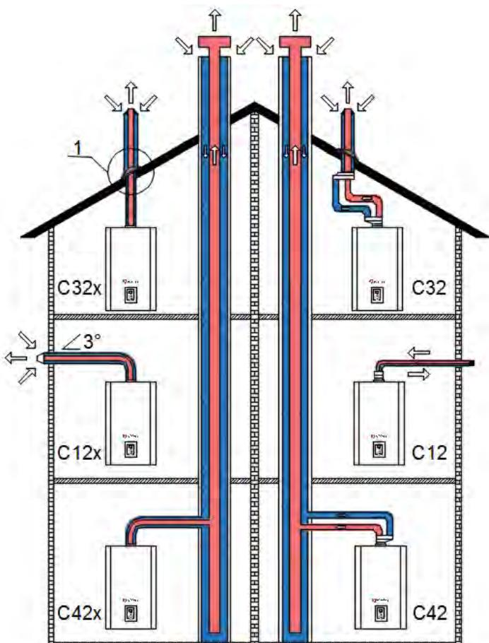
Рис 11. Типы систем дымоотведения C12, C32, C42.
