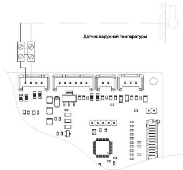
*Рис 19. Подключение датчика уличной температуры*
