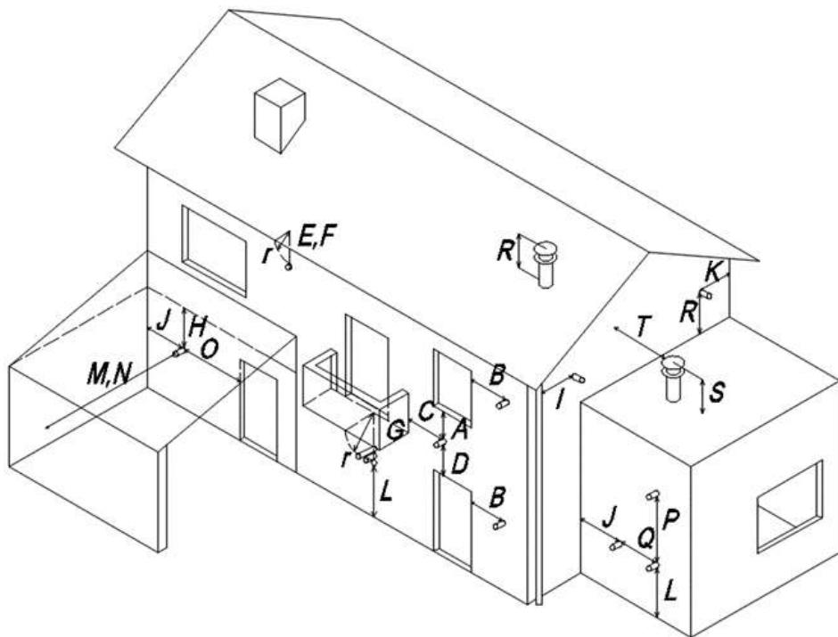
Рис 15. Расположение выходов дымовых труб.
